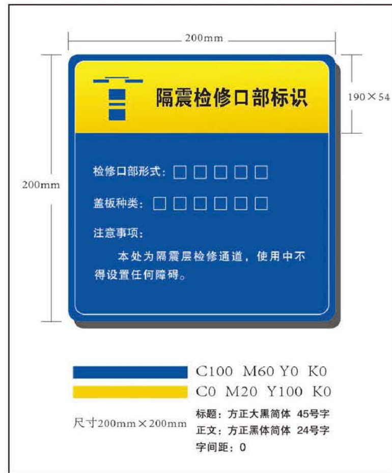
隔震检修口标识
