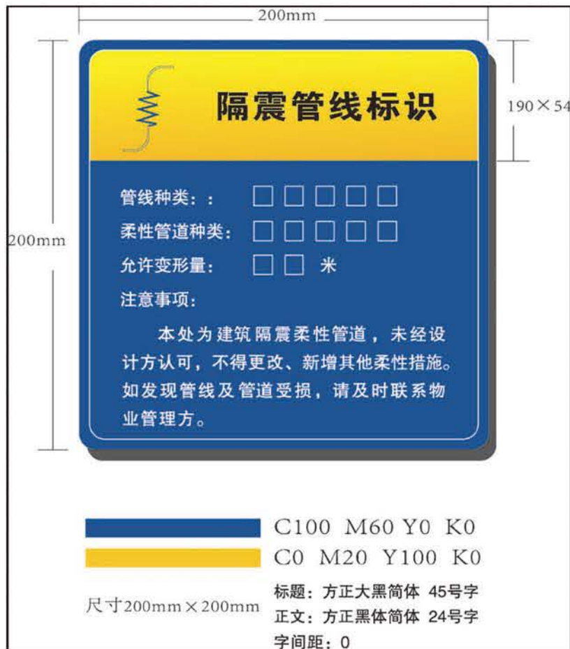
隔震柔性管道标识
