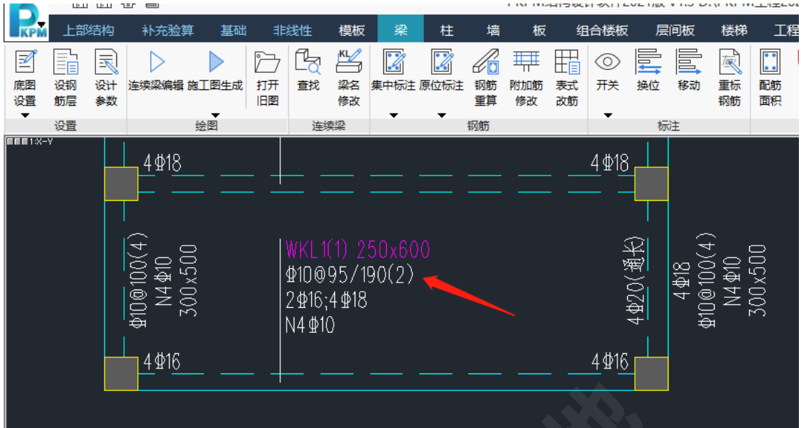
图 13 箍筋间距 95，小于 6d ( d 为纵筋直径) 限制
