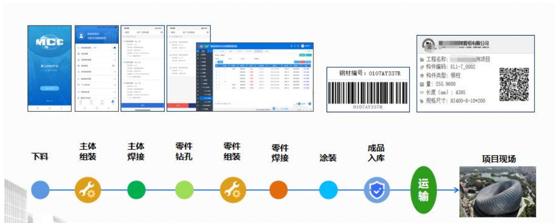
图 2 钢结构智能建造流程
