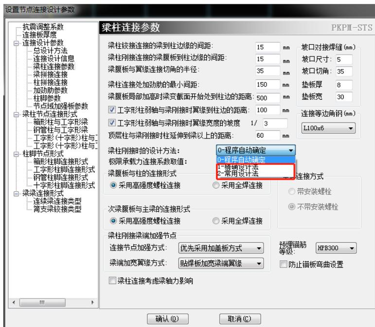
选择常用设计法或精确设计法参数，只影响梁柱直接连接节点形式的设计方法，对于短梁拼接方式的拼接部位程序默认按照精确设计法考虑，v5 版本以后新增了相关参数，需要在梁拼接参数中进行修改才起作用。如下图所示：
