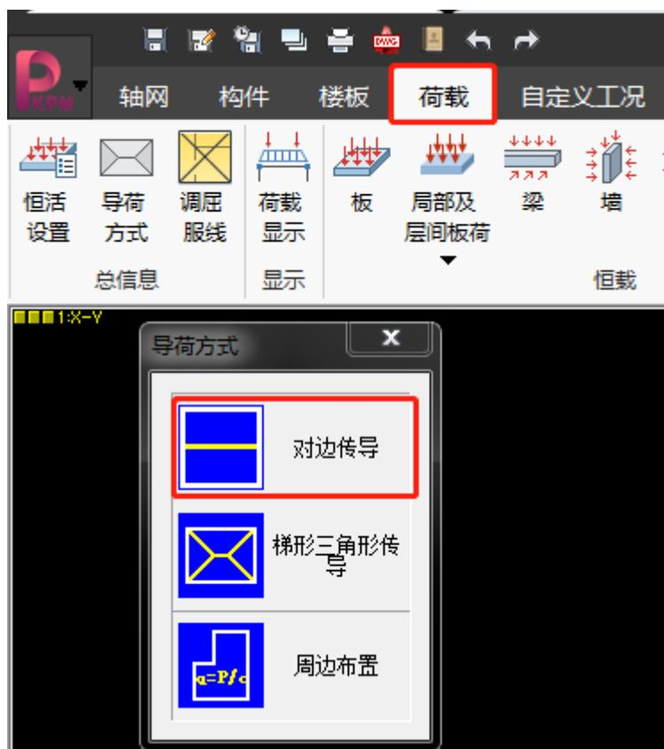
2. 在组合楼板和非组合楼板计算时，和其他普通混凝土板处理方式相同，程序根据楼板施工图中的参数定义—大于“双向板长宽比限值”时按照单向板计算，否则按照双向板计算，并不会因为布置了带肋的压型钢板而改变计算模式。
