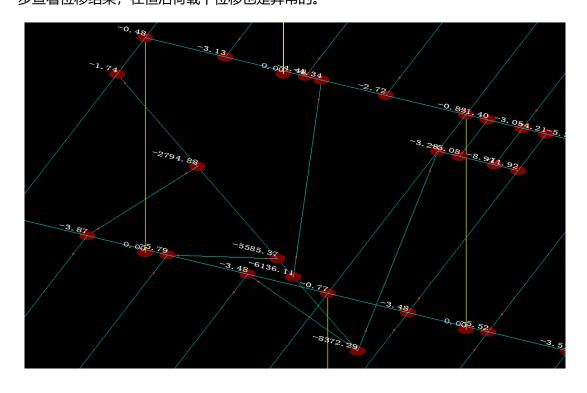
基本上可以判断模型建模存在问题,检查后发现模型中下图标出的节点铰接设置有误,使得这个节点转动自由度完全的被释放,该位置是几何可变的机构,所以会出现位移和挠度的异常,将这个位置铰接去掉后重新计算,由于机构解除,模型变为几何不变体系,此时计算结果是正常的。
