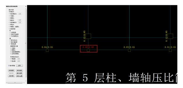
**A:**查看该柱的构件信息发现这根柱在恒载作用下就已经出现了明显的轴拉力,恒载出现轴拉力? 这与我们一般的常识显然不相符,问题转化为为什么在恒载作用下产生轴拉力?
