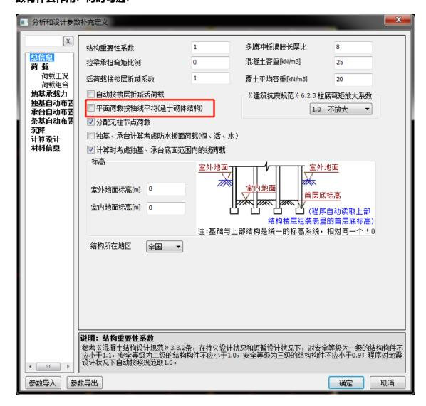
**A:**在读取 pm 平面荷载时,对于砌体墙荷载,当勾选平面荷载按轴线平均,程序会将该轴线上的所有相同工况的荷载求和,除以总的墙长,得到荷载平均值,然后作用到该轴线上,此时该轴线上的均布荷载值是完全相同的,如下图所示:
