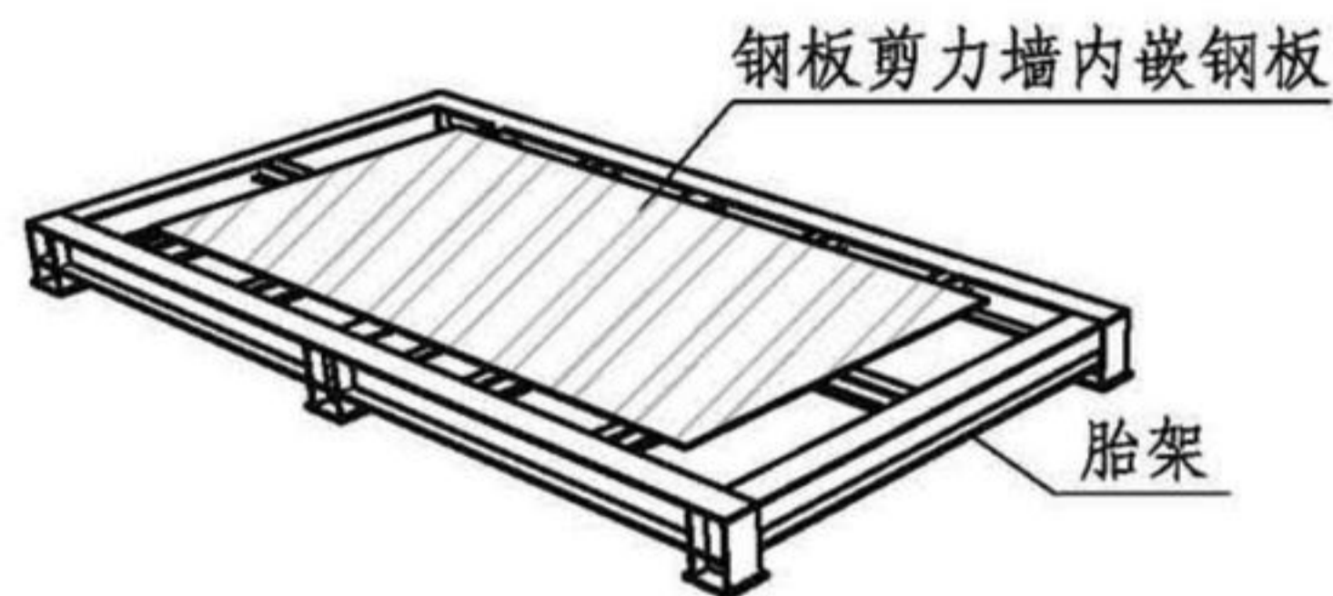
图1-4 钢板剪力墙内嵌钢板专用胎架
