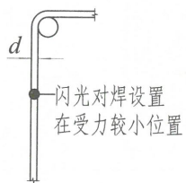
焊接封闭箍筋(工厂加工)
